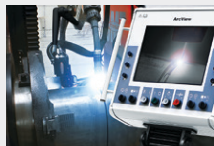
Система ArcView предоставляет пользователям детализированные снимки процесса сварки в режиме реального времени.
