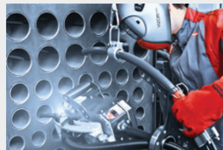
Недавно разработанная установка FTW 24-120 PRO для сварки соединений «труба–трубная доска».
