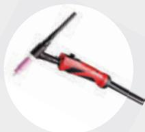
/ Новые сварочные TIG горелки легко использовать для конкретных требований благодаря возможности быстро и без дополнительных инструментов замены корпуса горелки. Это делает устройство практически универсальным.
