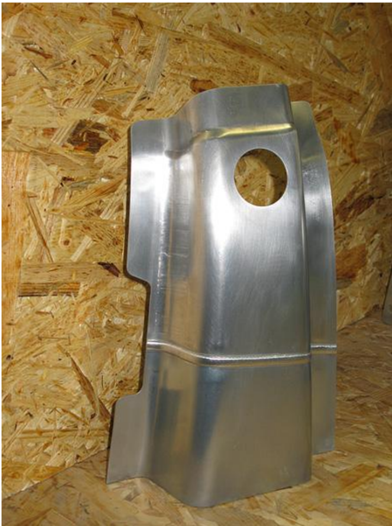
Рис. 8: Гибридные листы размером 300 × 220 мм, толщиной 1,2 / 1,5 мм подвергаются пайке-сварке на скорости 78 см/мин. перед формовкой по модели паяно-сварных несущих конструкций крыши.
