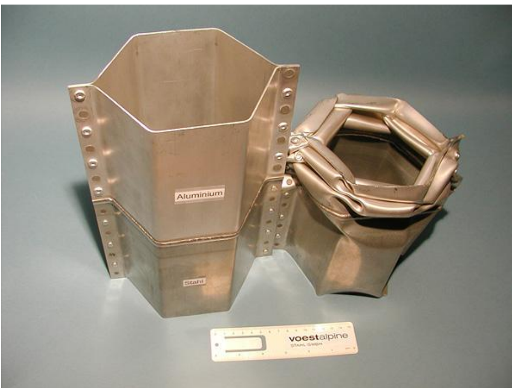
Рис.7: Паяно-сварной шов остается неповрежденным даже в ходе испытания элемента на удар.
