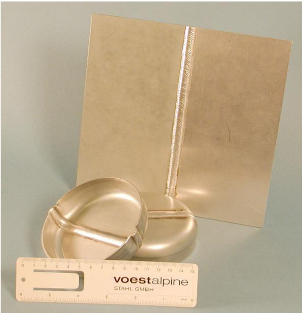
Рис. 6: «Испытание на вытяжку» ясно демонстрирует, что даже в пограничной зоне рассматриваемая технология обеспечивает хорошие результаты.
