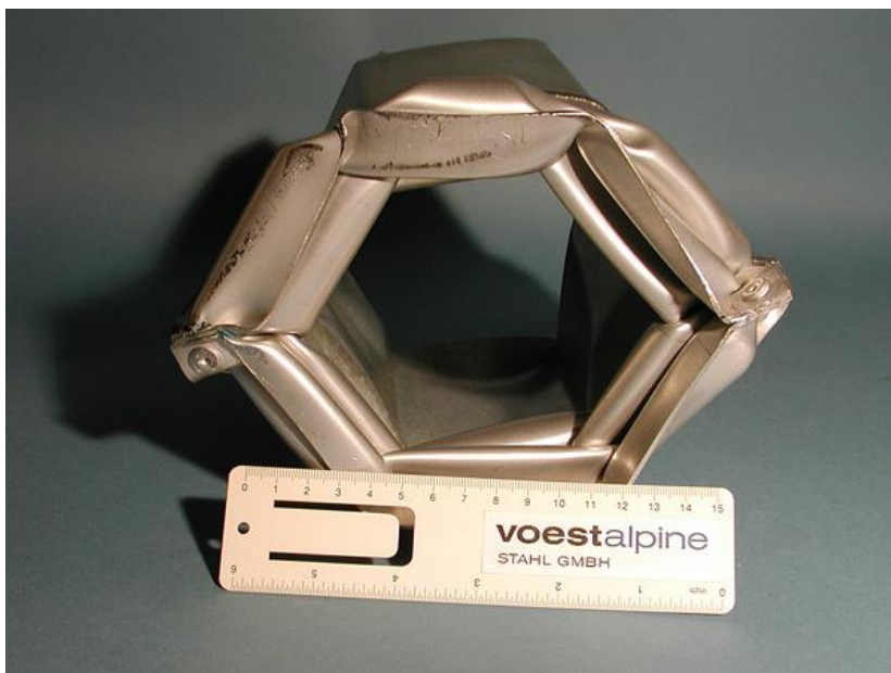
Рис. 1: Элементы, изготовленные из гибридных листов из металлов, способны систематически поглощать, например, энергию удара, возникающего в результате аварии.
