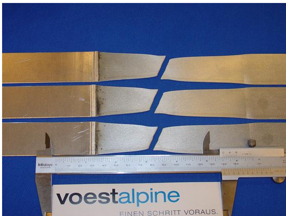
Рис. 2: Прочность паяно-сварного соединения настолько велика, что при проведении испытания на разрыв, разрыв происходит не в районе шва, а в алюминиевой части элемента.
